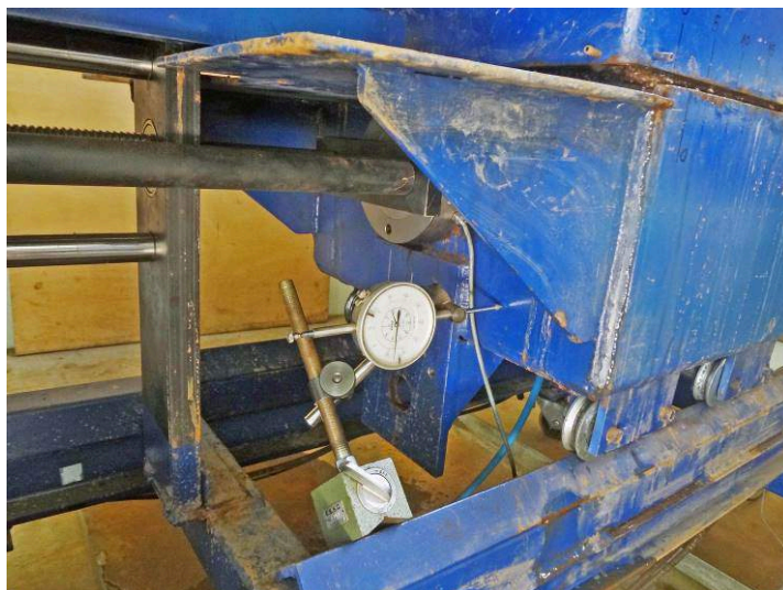
Figura 4.15 – Detalhe do relógio comparador utilizado para aferição da velocidade de avanço da metade inferior da caixa de ensaio, do sistema de aplicação da carga horizontal, da célula de carga e da aba que protege este sistema contra a queda de material do corpo de prova.
