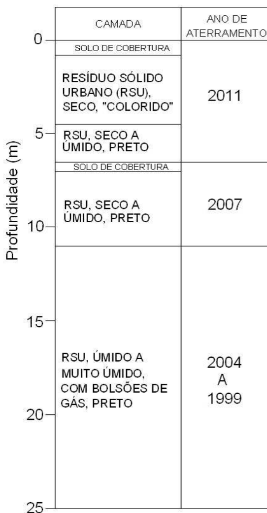
Figura 5.1 – Camadas atravessadas pelas sondagens no Aterro Sanitário de São Carlos
