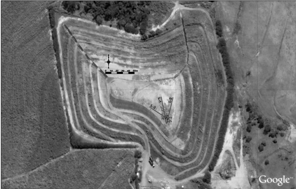
Figura 4.11 – Localização dos ensaios MASW (linhas L1 a L3) e dos furos F2, F4, F5 e F6, utilizados nos ensaios crosshole no Aterro Sanitário de São Carlos. (base: imagem aérea obtida em 04 de janeiro de 2012. Fonte: GoogleEarth, acessado em 15-03-2013).
