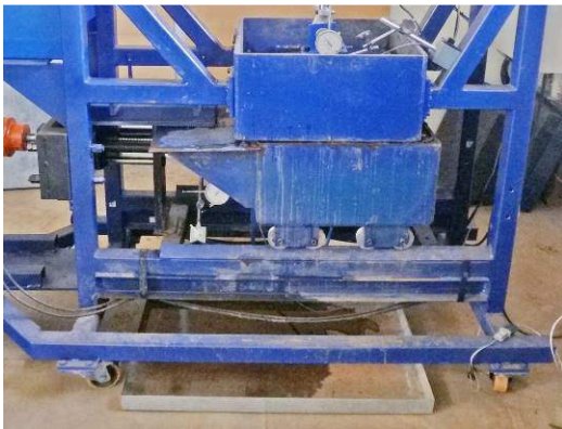
Figura 4.23 – (a) drenagem de água da amostra pelos orifícios e laterais da tampa de aplicação da carga vertical (b) drenagem de água da amostra pelo plano de cisalhamento e (c) bandeja colocada sob o equipamento de ensaio para captação da água que saía do corpo de prova.
