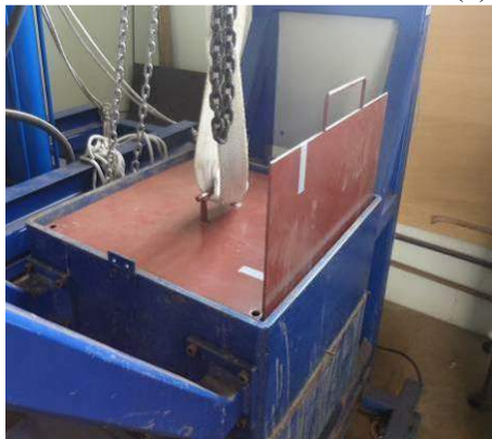
Figura 4.20 – (a) molde metálico vazio (b) moldagem do corpo-de-prova (c) aspecto do molde com colarinho (d) colocação da tampa (e) rotação das camadas (f) colocação do corpo de prova na caixa de ensaio (g) retirada da tampa (h) retirada do molde metálico.
