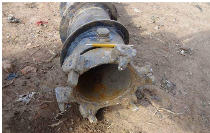
Figura 4.6 – Detalhe da coroa dentada que realiza a escavação do furo de sondagem, engatada na extremidade inferior do conjunto de trados de haste oca.
