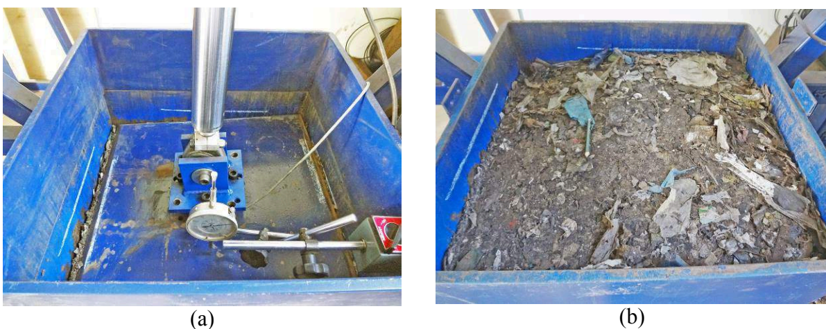
Figura 4.19 – (a) final do ensaio de cisalhamento realizado com a amostra A2011 – observar que a amostra está “descolada” da parede da caixa de ensaio no lado esquerdo (b) com a remoção do carregamento vertical a amostra expande, encostando novamente na parede lateral da caixa de ensaio e ultrapassando parcialmente a marca de giz da parede do fundo.
