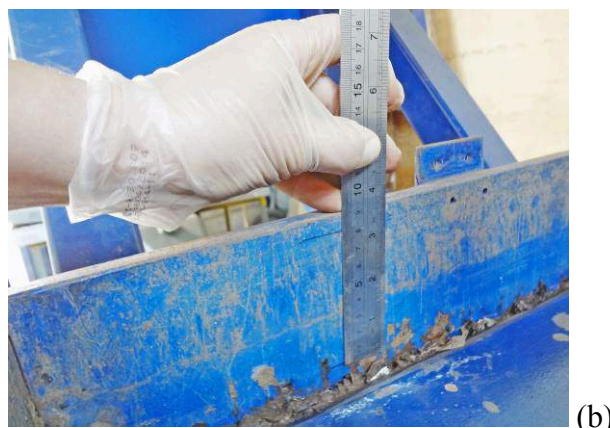
Figura 4.16 – (a) detalhe da barra metálica solidarizada ao pistão de aplicação da carga vertical (b) registro dos afundamentos diretamente na parede da caixa de ensaio.
