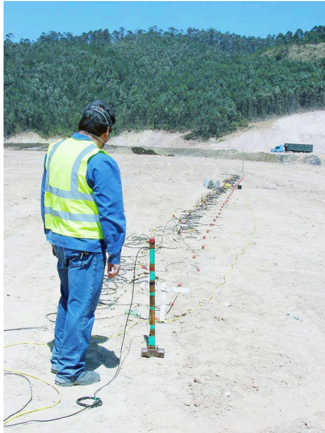
Figura 3.27 – Arranjo do método MASW (uma fonte e 24 geofones em linha).
