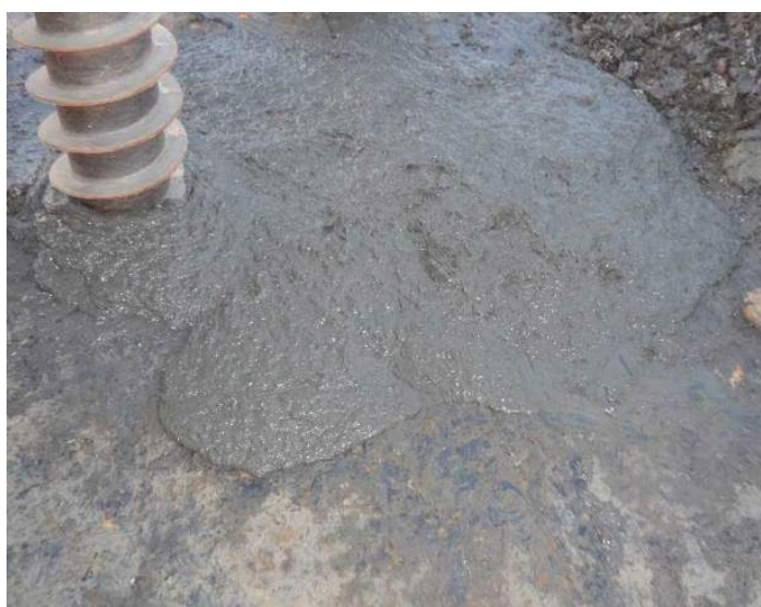
Figura 5.18 – Aspecto de trecho de RSU co-disposto com lodo de estação de tratamento de esgotos assim que chega à superfície – furo 1, entre 7,0 e 10,0 metros de profundidade.
