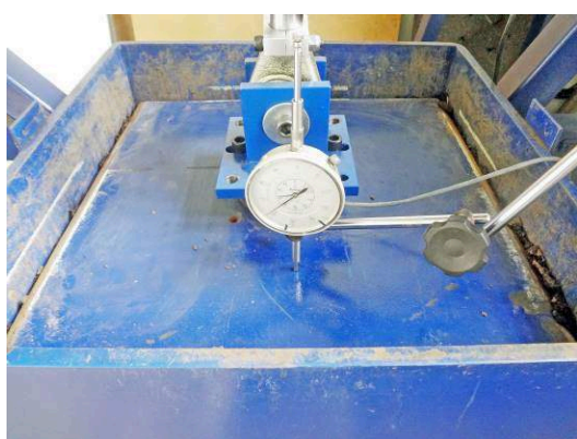
Figura 4.17 – Aspecto da tampa que aplica o carregamento vertical sobre o corpo-de-prova no início do ensaio (a) e no final (b).
