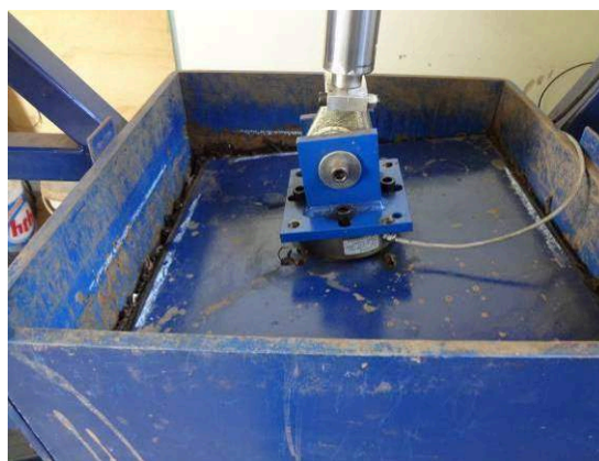
Figura 4.17 – Aspecto da tampa que aplica o carregamento vertical sobre o corpo-de-prova no início do ensaio (a) e no final (b).
