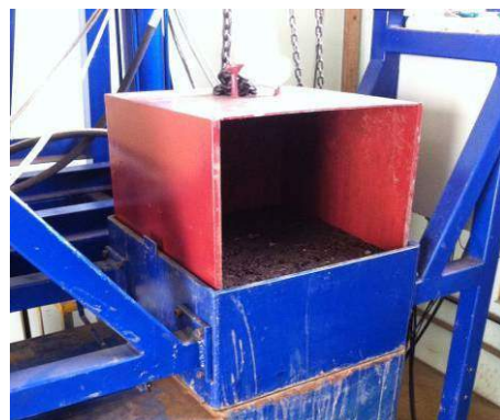
Figura 4.20 – (a) molde metálico vazio (b) moldagem do corpo-de-prova (c) aspecto do molde com colarinho (d) colocação da tampa (e) rotação das camadas (f) colocação do corpo de prova na caixa de ensaio (g) retirada da tampa (h) retirada do molde metálico.
