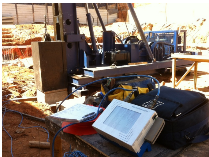
Figura 2.24 – Equipamento de aquisição de dados na PCD (Rosa, 2013).
