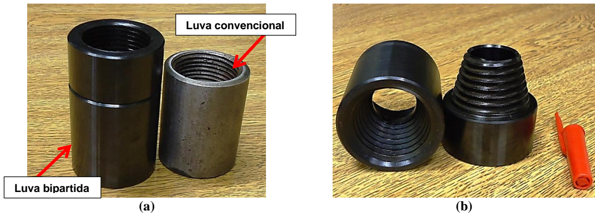
Figura 3.9: Luva bipartida, utilizada nos ensaios de campo: (a) Comparação entre os dois tipos de luvas e, (b) Sistema de rosca cônica.
