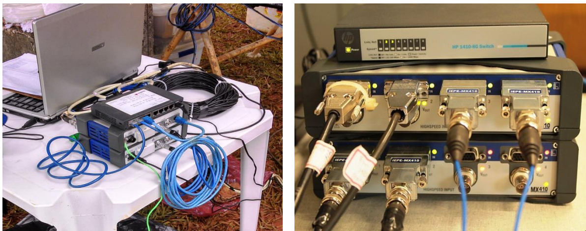
Figura 4.5: Sistema de aquisição de dados simultâneo utilizado, HBM modelo MX 410.
