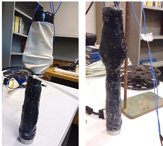
Figura 3.14: Proteção mecânica dos sensores instalados na haste instrumentadas.
