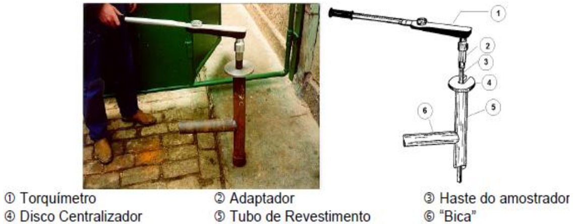
Figura 2.2: Esquema do torquímetro acoplado ao topo da composição de hastes no ensaio SPT (ALONSO, 1994 adaptado por PEIXOTO, 2001).
