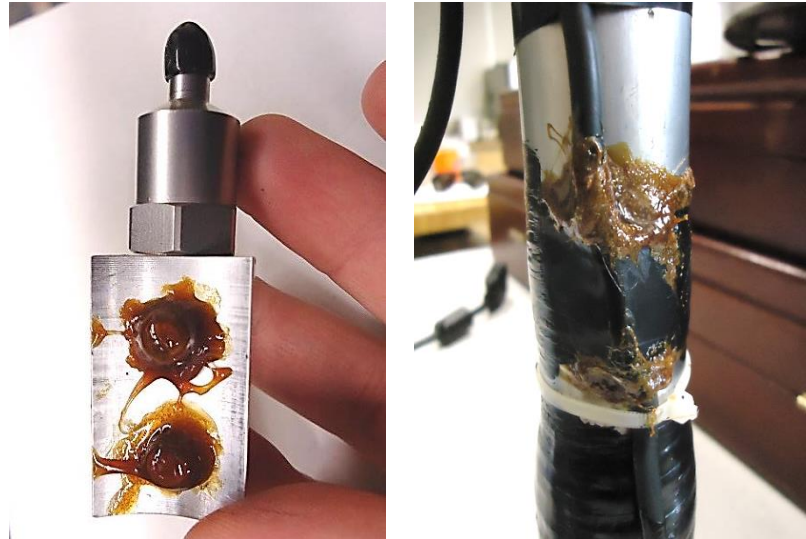
Figura 3.13: Impermeabilização das aberturas e dos cabos dos sensores.
