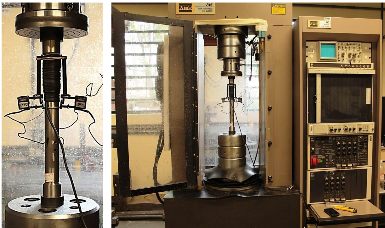
Figura 3.5: Calibração da célula de carga das hastes instrumentadas.
