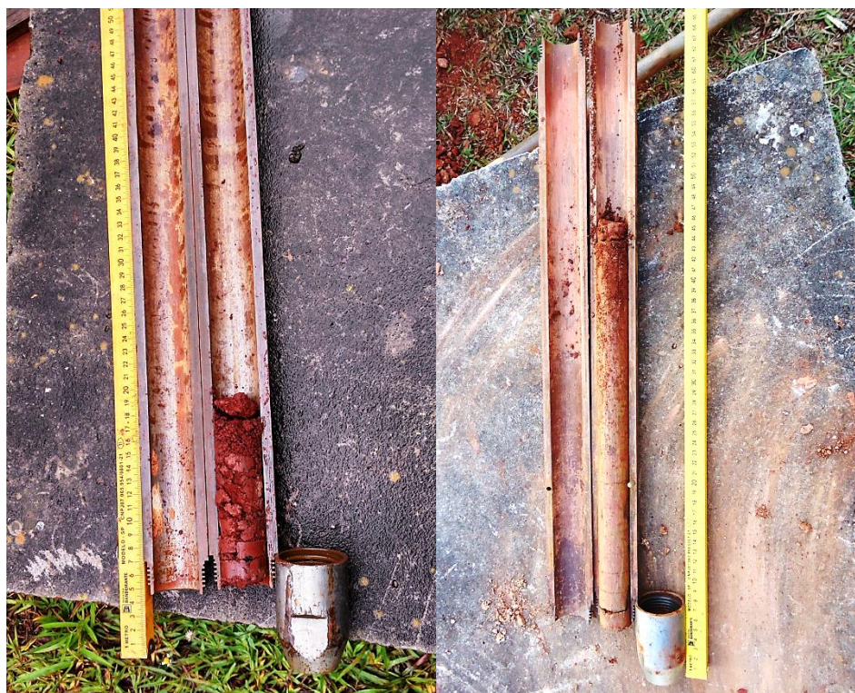
Figura 4.7: Controle da recuperação de amostra: A) houve embuchamento e, B) não houve embuchamento.
