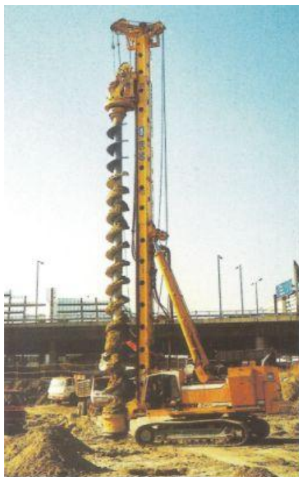
Figura 2.34 Vista da perfuratriz modelo BG 30. (BAUER MASCHINEN, 1994).
