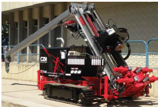
Figura 2.87 Perfuratriz MC140 em posição de transporte. (CZM, 200-?).
