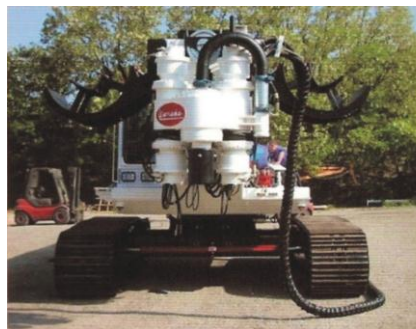
Figura 2.27 Detalhe da mesa rotativa da perfuratriz P-140TT. (LLMADA, 2009).
