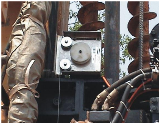
Figura 2.49 Vista frontal do conjunto de medida de profundidade. (E.G. BARRETO, 2010).
