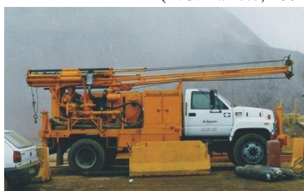
Figura 2.71 Sonda CME 55 que utiliza trado hollow-auger na execução de diversos ensaios. Alphageos (2000).
