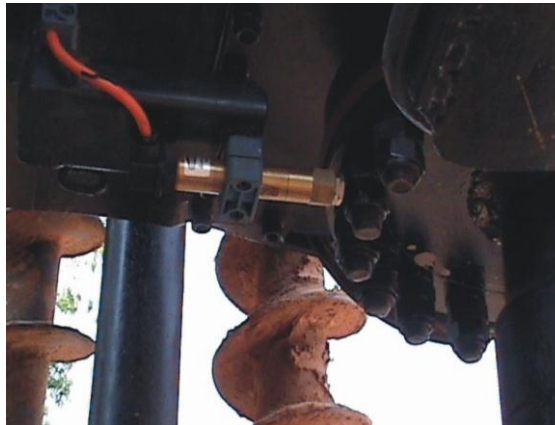
Figura 2.48 Sensor de velocidade de rotação. (E.G. BARRETO, 2010).
