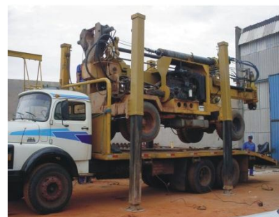
Figura 2.40 Sistema hidráulico de autocarregamento (BARRETO, 2005).
