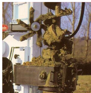
Figura 2.28 Perfuratriz P – 90 TT. Vista do limpador de trado. (LLMADA, 2009).
