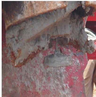
Figura 2.2 Ponteira da hélice com vista da tampa.
