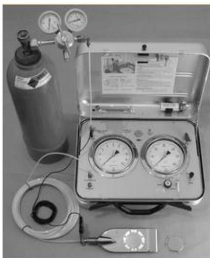
Figura 2.110 Vista do equipamento para a realização de ensaios dilatométricos. Marchetti (2010).
