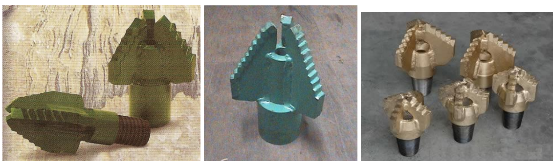
Figura 2.76 Broca de três asas tipo tricône. (TECTOOLS, 200-?; EG BARRETO, 2010 e ROCKSMITH, 2011).
