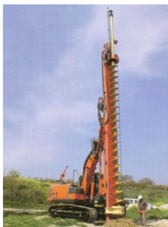
Figura 2.12 Perfuratriz modelo EK90 CFA. (GEAX, 2009).
