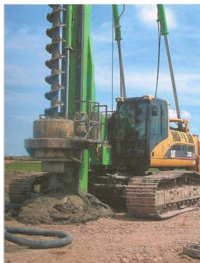
Figura 2.7 Perfuratriz CA 80 S/30 com sistema “Bottom – Drive”. (CLO ZIRONI, 2006).
