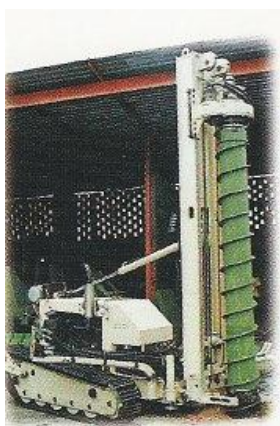
Figura 2.69 – Equipamento sobre esteiras com trado hollow-auger (Cló Zironi, 199?).
