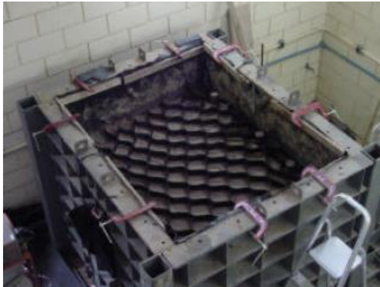
Figura 23 – Camada de geocélula pronta para o recebimento do material de preenchimento (MENESES, 2004)
