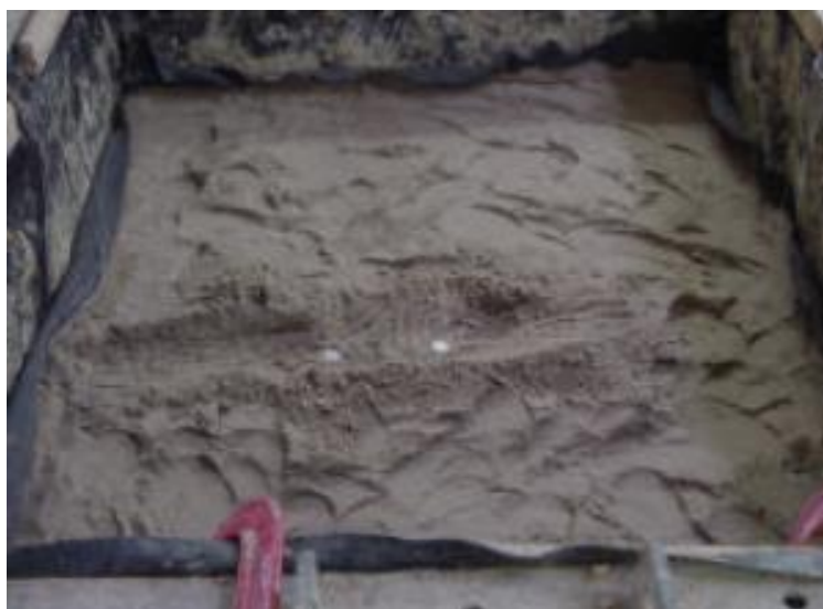
Figura 22 – Camada de areia de regularização com a disposição das células de tensão total logo abaixo da camada de geocélula (adaptado de MENESES, 2004)
