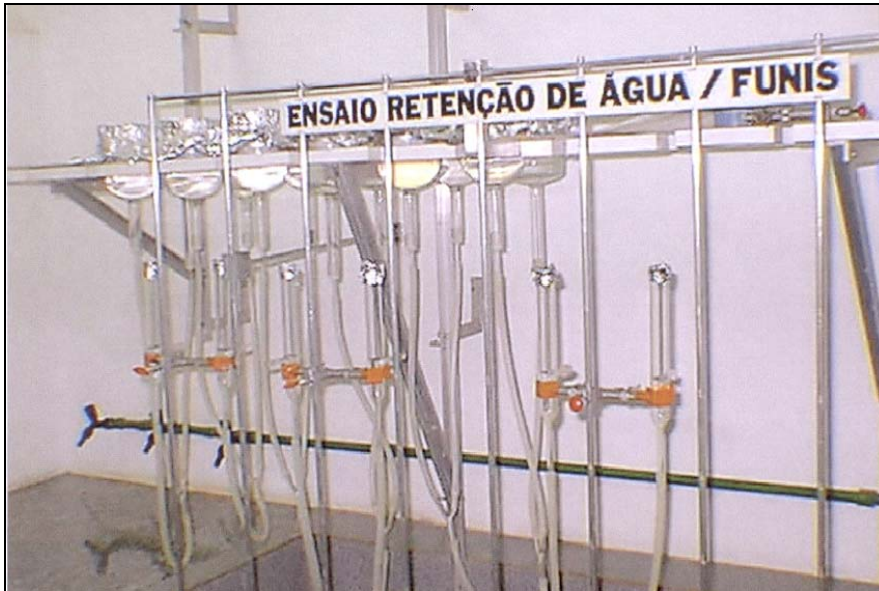
Figura B.7 – Funis de Haines de placa porosa à tensão de sucção de 30 cm de coluna de água, FRANCHI (2000).
