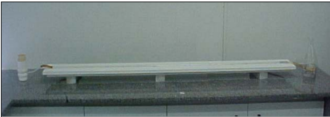
Figura IV.15 – Ensaio de infiltrabilidade – Metodologia MCT
