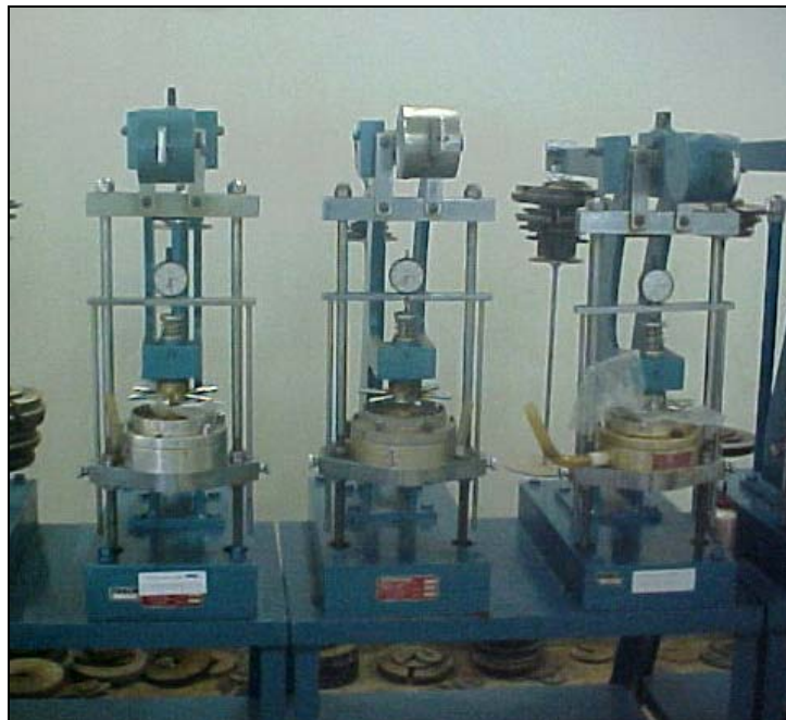
Figura IV.11 – Ensaios edométricos convencionais na condição natural e inundada.
