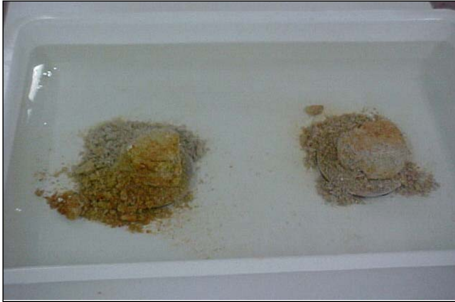
Figura IV.19 – Ensaio de desagregação (amostras praticamente desagregadas)
