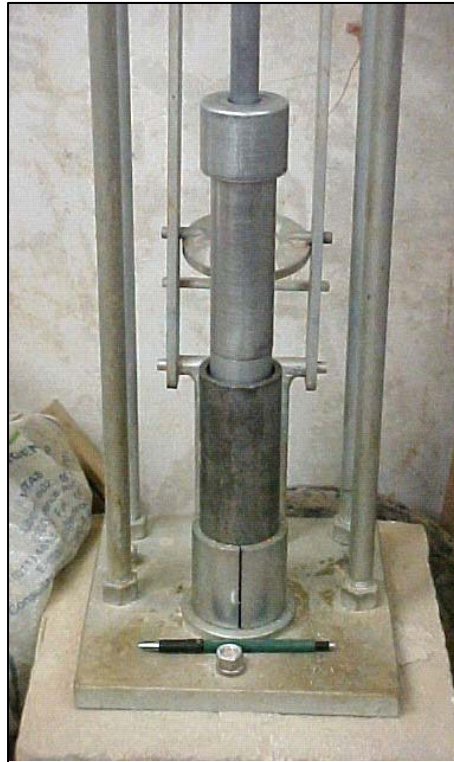
Figura IV.10 – Compactação das amostras no ensaio MCT
