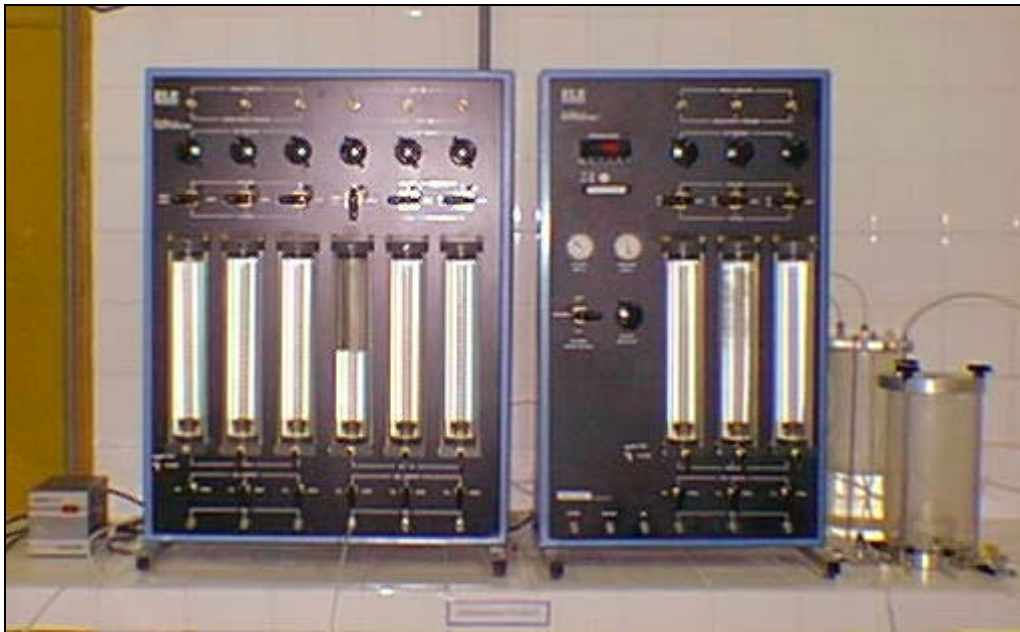
Figura IV.6 – Ensaio de condutividade hidráulica com o Tri Flex 2
