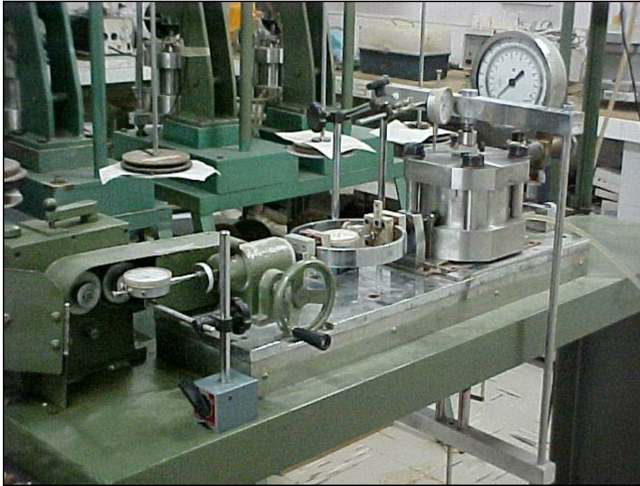
Figura IV.13 – Ensaio de cisalhamento direto com sucção controlada
