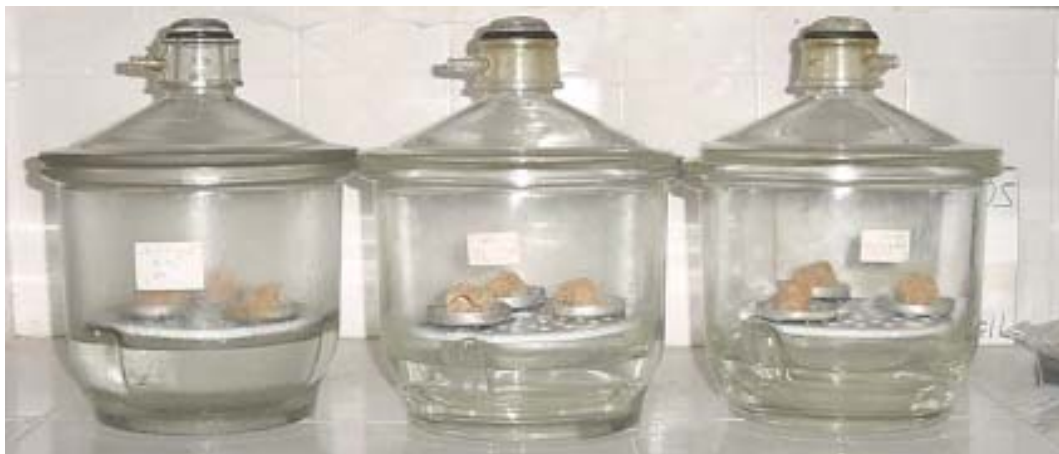
Foto III.7 – Dessecadores de vácuo com amostras de solo.
