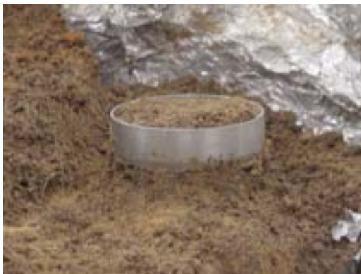
Foto III.10 – Moldagem dos corpos de prova do ensaio edométrico.
