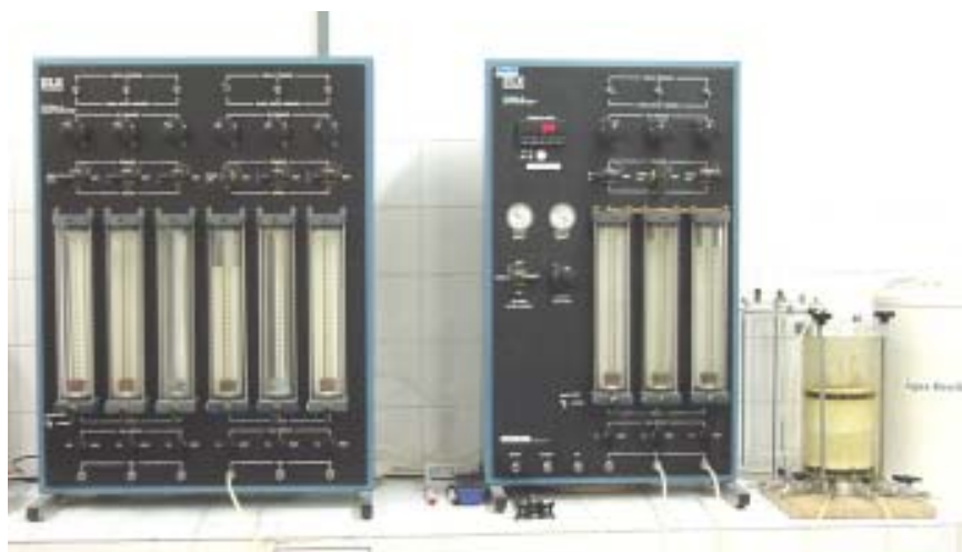
Foto III.8 – Tri-Flex 2, equipamento para obtenção da condutividade hidráulica em laboratório.
