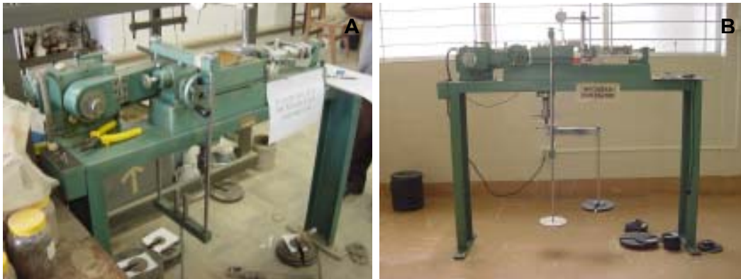
Foto III.11 – Prensas de cisalhamento LSI/ UFPE (A) e LABGEO/UNICAP (B).
