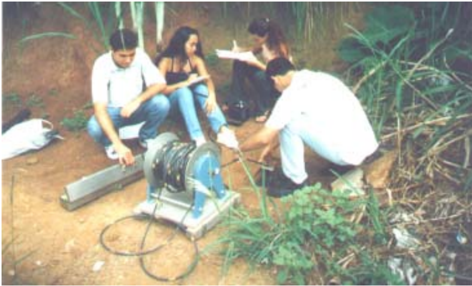
Foto III.5 – Instrumentação dos deslocamentos horizontais da encosta.
