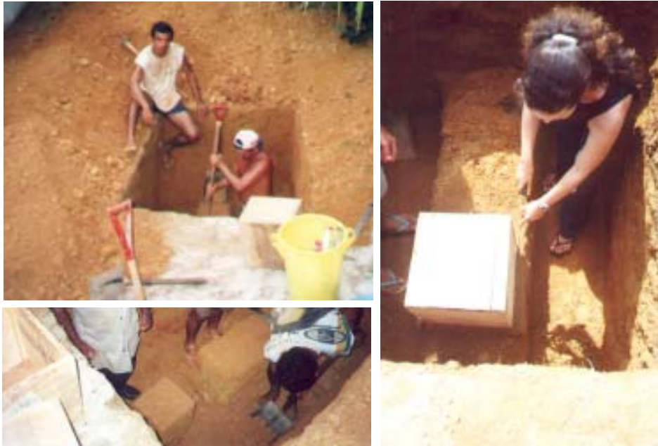
Foto III.1 – Coleta de amostras indeformadas (tipo bloco).
