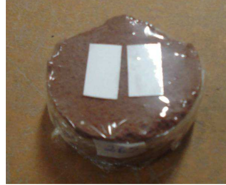
Figura 3.3b – Corpo-de-Prova para o ensaio de sucção matricial
