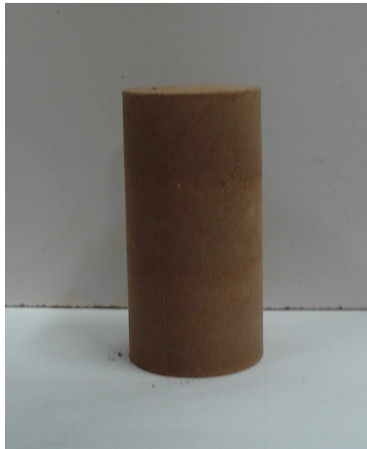
Figura 3.1 – Corpo-de-prova de solo-cinza-cal
