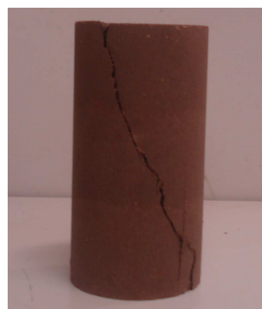
Figura 4.18b – Plano de ruptura típico
