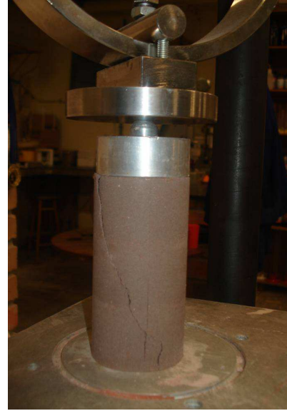
Figura 3.2b – Corpo-de-prova de solo-cinza-cal no ensaio de Compressão Simples
