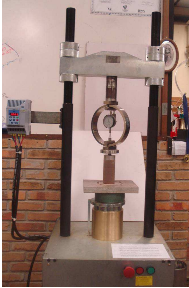
Figura 3.2a – Ensaio de Compressão Simples
