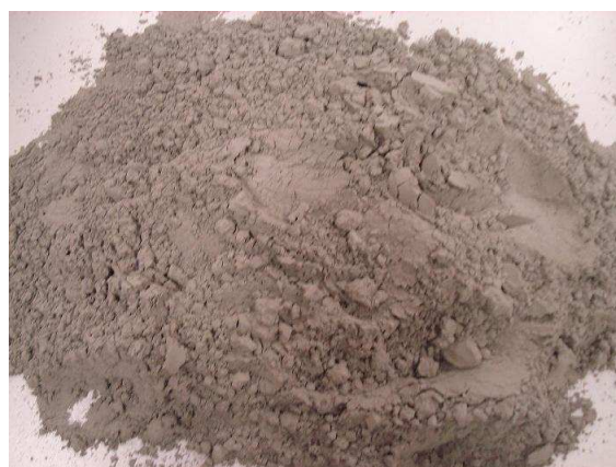
Figura 3.8b – Cinza volante da Usina Termelétrica de Charqueadas-RS
