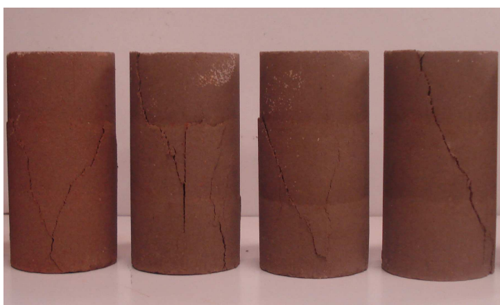
Figura 4.18a – Corpos-de-prova submetidos à compressão simples
