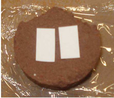
Figura 3.3a – Corpo-de-Prova para o ensaio de sucção matricial
