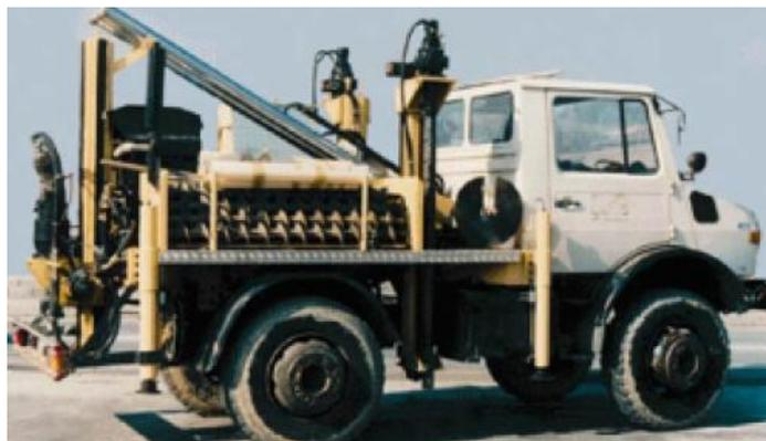
Figura 3.4 – Cone com a estrutura de reação constituída por caminhão.
