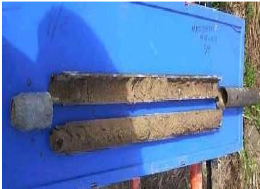
Figura 3.2 – Amostrador padrão SPT, bi-partido para a coleta de solo.
