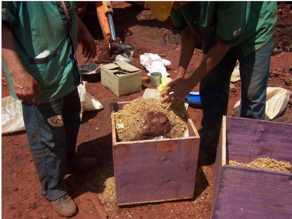
Figura 5.4 – Acondicionamento dos blocos indeformados.
