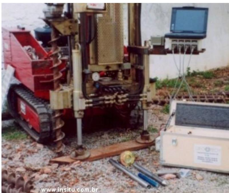
Figura 3.6 – Cone sobre esteiras com a aparelhagem de aquisição de dados.
