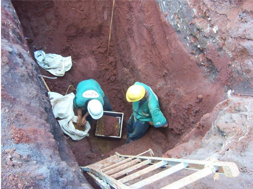
Figura 5.3 – Abertura de poço e coleta de bloco indeformado.
