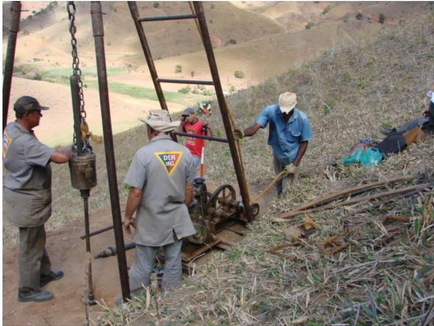
Figura 3.1 – Execução de um ensaio SPT, tripé e apetrechos da sondagem.
