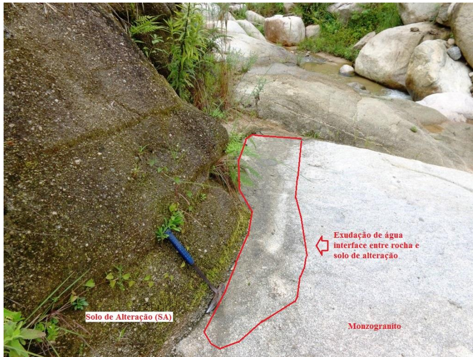
Figura 4.21 – Exudação de água na interface entre rocha alterada e rocha sã – Ponto 18
