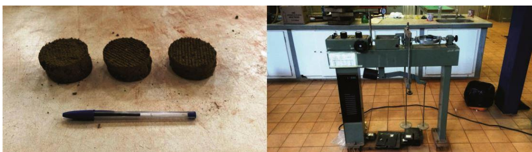
Figura 1.6 – Ensaio de cisalhamento direto - Laboratório de Mecânica dos Solos, FEC-UNICAMP.
