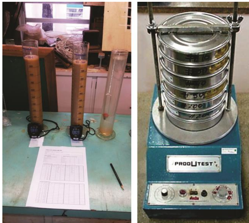
Figura 1.5 – Ensaios de sedimentação e peneiramento. Laboratório de Mecânica dos Solos, FEC-UNICAMP.
