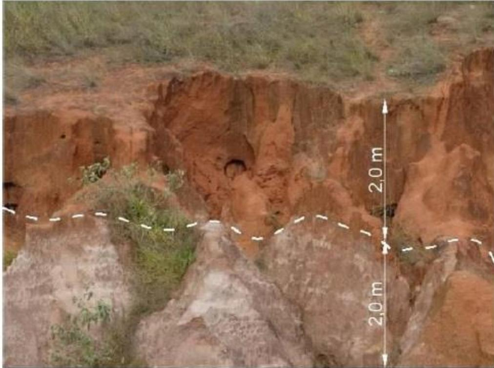
Figura 13 – Contato do solo com a rocha e espessura aproximada. Ocorrência de *pipes* (arquivo pessoal).
